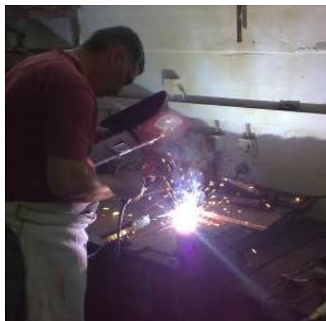
Слика 5 Пробно експерименталне заваривање Е-поступком са рутилном и базичном електродом
