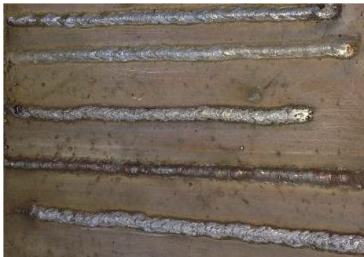
Слика 6 (а,б) Изглед навара добијеног Е-поступком са рутилном и базичном електродом
