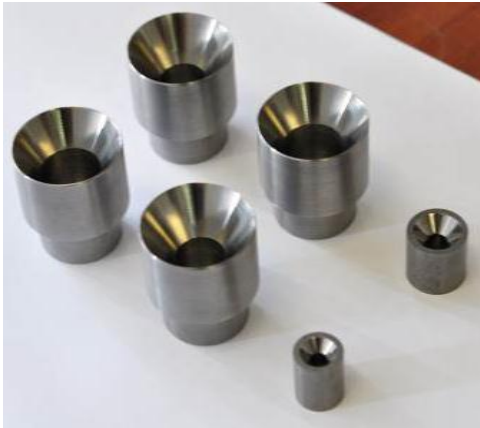
Слика 3. Изглед гарнитуре алата-матрица за формирање облоге одговарајуће дебљине и прчника
