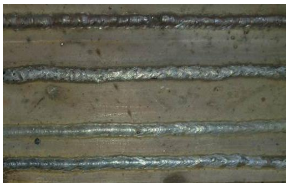
Слика 6 (а,б) Изглед навара добијеног Е-поступком са рутилном и базичном електродом
